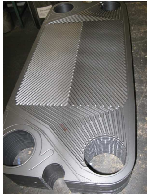
(Assemblage de plaques en graphite pour les échangeurs)
